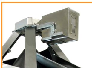
Bevor das Teig die Maschine verlässt, kommt es am Mehlstreuer vorüber. Dieser Verteiler kann mehr oder weniger Mehl verteilen, indem man die Bleche unten einstellt. Nachdem das Teig an diesem Streuer vorübergekommen ist, erreicht es den Ausgang (C).
