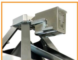
Avant que la pâte atteigne la sortie, elle doit passer sous le farineur. Ce distributeur peut être réglé pour diffuser plus ou moins de farine en adaptant les plaques au dessous.
