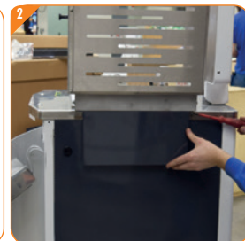
Étape 10 : Monter le couvercle sur le côté de la machine
