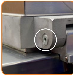
Étape 8 : Fixer le cadre de grille avec les vis courtes, les rondelles et les rondelles élastiques sur les deux côtés
