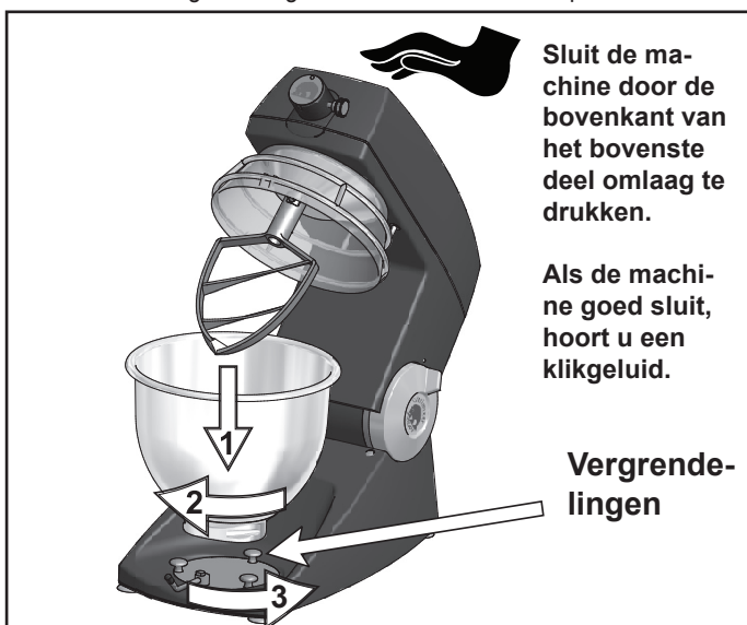
fig.5: Plaats de kuip in de menger en draai hem tot hij vergrendelt. Draai de vergrendelingshendel linksom om de kuip vast te houden.
