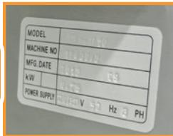
Alvorens de machine aan te koppelen, gaat u het best op het fabricageplaatje de spanning na, om te zien of die overeenstemt met de spanning van het elektriciteitsnet.
