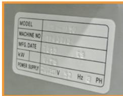
Avant de brancher la machine, il faut contrôler si le voltage qui est indiqué sur la plaque signalétique correspond bien à celui du réseau électrique.
